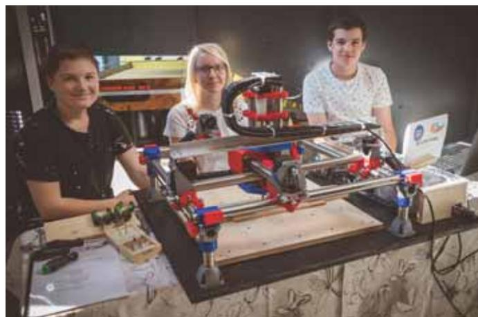
fünf Schrittmotoren verbaut. Zum Ansteuern dieser Motoren dienen ein Mikrocontroller und eine Steuerungsplatine. Und schon hat man fast alles, was man für eine brauchbare Hobbyfräse benötigt. Interesse geweckt?
